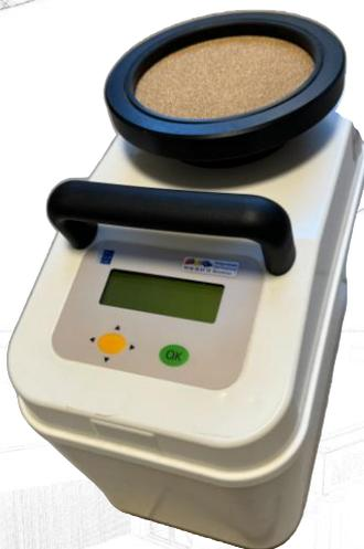
Les préleveurs PA300/1000/2000® sont utilisés pour la surveillance des lieux de travail, les interventions sur zones à risques radiologiques ou chimiques ou encore la réalisation de contrôles.
